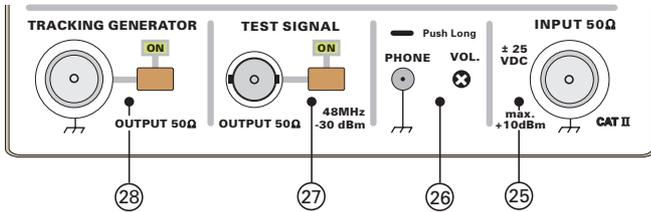
**(27) TEST SIGNAL** - BNC-Buchse mit Drucktaste und zugeordneter LED
