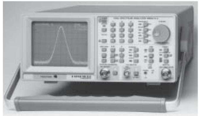
nachgebildete Netzwerkanalysator ermöglicht Verstärkungs- und Dämpfungsmessungen. Der Ausgangspegel ist zwischen **–50dBm** und **+1dBm** in **0,2dB Schritten** mit Tastatur oder Drehgeber veränderbar.
